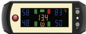
**快速漏氣警告模式**：當輪胎有急速洩氣狀況發生時。(30秒內壓力變化超過3 psi或20kPa以上時)
