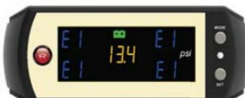
收訊不良警告模式：當無線接收顯示器沒有接收到任一發射器發射之訊號且狀況時間持續超過10分鐘時。
