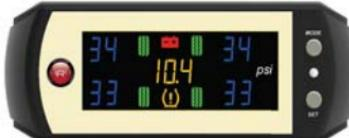
**發射器內裝電池低電壓警告模式**：當發射器內裝電池處於低電壓狀況時。
