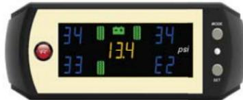
註：1.在警告模式發生時，按壓**模式鍵(MODE)**持續超過3秒鐘可消除蜂鳴器警告音。
