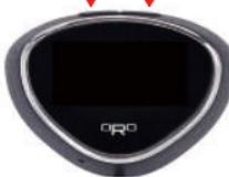
長按接收顯示器的**設定鍵(左鍵)**3秒可進入設定模式，進入後短按**設定鍵(左鍵)**可以切換設定模式，W207共有3組可供使用者變更出廠設定值的設定操作，依序為前輪標準胎壓設定值、後輪標準胎壓設定值、輪胎高溫警告設定值等參數的設定變更，其操作方式詳述如下：
