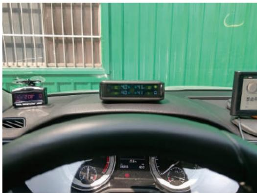
**注意：接收顯示器需擺放在前擋風玻璃下方，才能確保接收顯示器能接收太陽光充電並確保四輪位置學習正確。**
