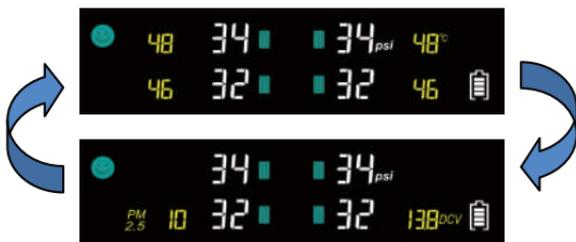
**註：**若沒有選配PM2.5&電瓶電壓檢測器，則在主畫面下短按左鍵沒有任何作用。
