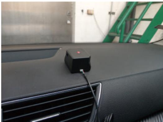
b.將PM2.5&電瓶電壓檢測器電源線插頭插入車上點菸座即完成安裝。
