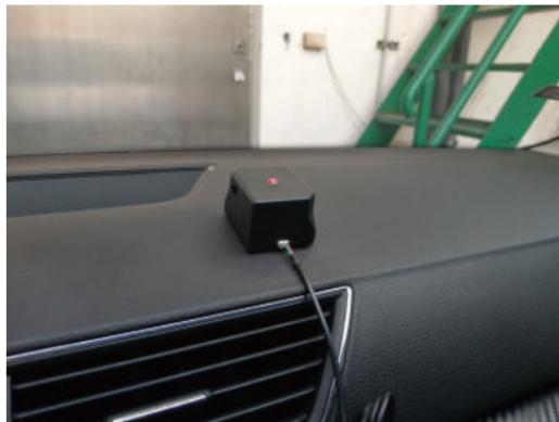
b.將PM2.5 檢測器電源線插頭插入車上點菸座即完成安裝。
